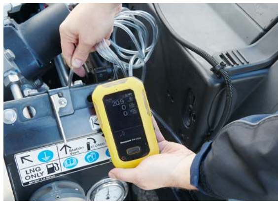
Mobile Gasdetektoren unterstützen die Suche nach Gaslecks.
