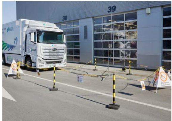
Beim Abblasen von Gas ist der Sicherheitsbereich abzusperren.
