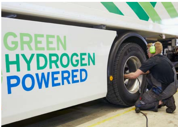
Das Sicherheitsniveau S 1 ist für alle Arbeiten vorgesehen, die keinen direkten Eingriff in das Gassystem erfordern.
