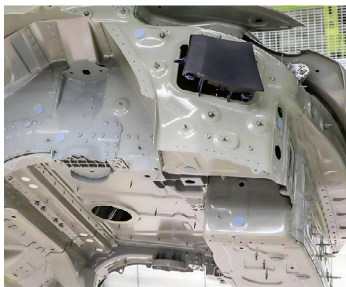
Karosseriebleche, Strangpressprofile und gegossene Teile können künftig mit additiv produzierten Karosserieteilen kombiniert und damit das Optimum punkto Festigkeit und Masse herausgeholt werden. Foto: Porsche
