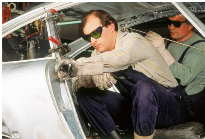
Karosserierohbau anno dazumal: Die Karosseriebleche eines Porsche 911 werden durch Punktschweissen zusammengefügt. Viel Handarbeit sorgt für entsprechend hohe Kosten in der Fertigung. Foto: Porsche
